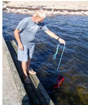
Opdrift testes for at se om de holder opdriften på 50 Newton.
